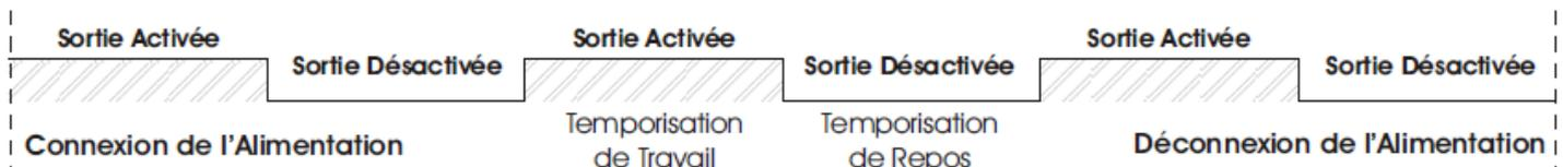
Une fois le temps sélectionné, vous devrez activer l'interrupteur pour alimenter le module. Le module I-10 connectera automatiquement la sortie durant le temps de travail préalablement ajusté, en allumant le led indicateur. Lorsque la temporisation sera fini, le led et la sortie se déconnecteront, demeurant dans cet état pendant le temps de repos que vous aurez établi; et une fois ce temps de repos écoulé le cycle s'initiera de nouveau.
