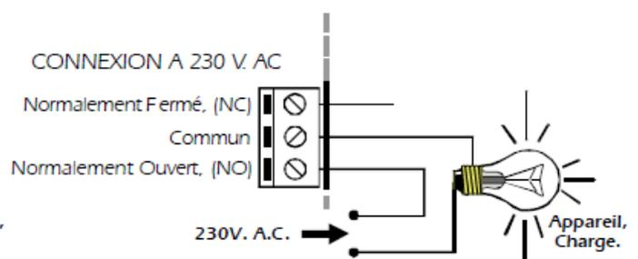
**CONSIDERATIONS SUR LA SORTIE :** .Durant le fonctionnement, et selon sa charge, il est possible qu'il se produise une fluctuation ou un fonctionnement incorrect de la sortie. Si cela venait à se produire, placez un circuit "anti-étincelles" (Condensateur de typo X2 de 100 nF/400 V. et résistance de  $47 \cdot \frac{1}{2} W.$ ), entre les deux contacts du relais utilisés pour la connexion, (Voir schéma ci-joint).
