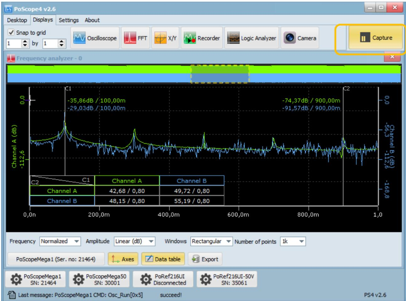
Analyseur de fréquence en mode analyse avec fenêtre de présentation.
