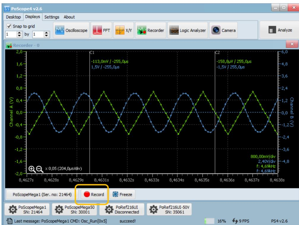
**REMARQUE :** Le bouton d'enregistrement n'est visible que si le périphérique source est en **mode PIPE**. L'enregistrement n'est pas possible dans **MODE TAMPON**.
