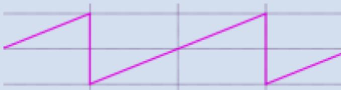
Pour vous montrer l'utilisation de base du générateur de fonctions, nous avons connecté deux sondes au PoScope Mega1 +, le premier à la sortie du générateur de fonctions et le second au canal A de l'oscilloscope. Connectez les deux petites pinces des sondes ensemble et exécutez le générateur de fonction à 5 kHz.
