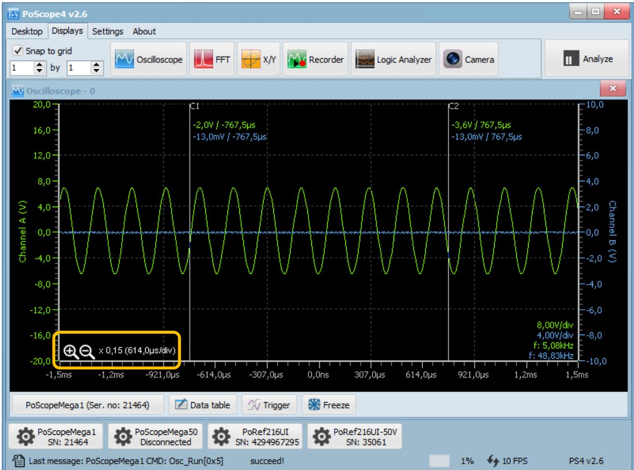
Icônes en forme de loupe pour le réglage de la base de temps.
