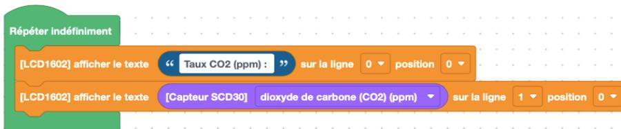
5) Dans le menu supérieur, cliquer sur le bouton "Vérifier" pour vérifier qu'il n'y a pas d'erreur de syntaxe puis cliquer sur "Envoyer" pour que le programme soit directement téléversé dans la carte Arduino Uno.
