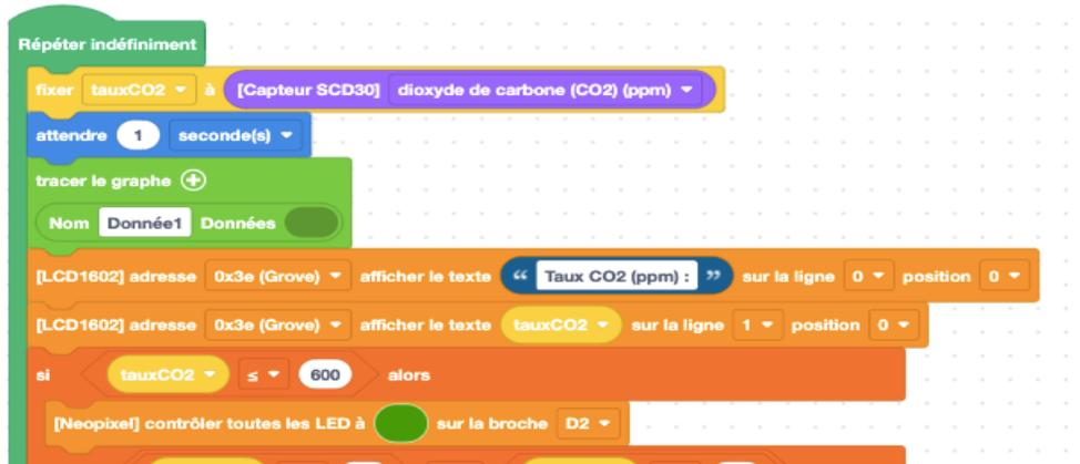
Il est possible de changer le nom "Donnée1" par un titre plus explicite (par exemple "Taux de CO2 en ppm"). Il faut aussi indiquer que les "Données" utilisées sont celles collectées par la variable "TauxCO2". Ainsi, il est nécessaire de modifier le bloc de la manière suivante :
