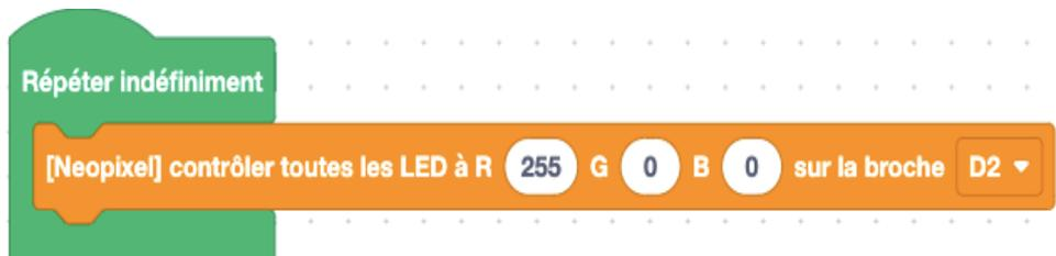
**4)** Dans le menu supérieur, cliquer sur le bouton "Vérifier" pour vérifier qu'il n'y a pas d'erreur de syntaxe puis cliquer sur "Envoyer" pour que le programme soit directement téléverser dans la carte Arduino Uno.
