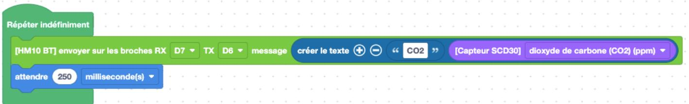
Les valeurs du taux de dioxyde de carbone mesurées par le capteur SCD30 sont émises via le module Bluetooth HM10.
