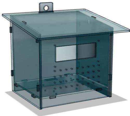
L'abris pour station météo permet de disposer d'un élément de protection et de support dédié à vos capteurs. Libre à vous de le construire pour répondre à vos contraintes, de le doter d'un module d'alimentation électrique fonctionnant avec une batterie et un panneau solaire
