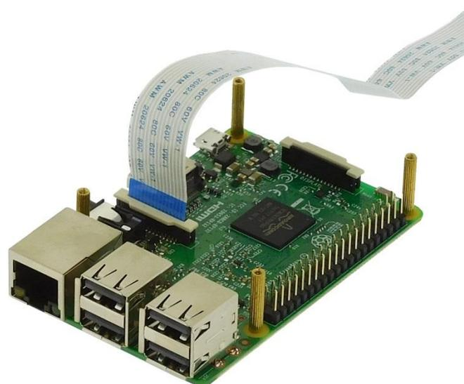
Fixez la carte Raspberry Pi 3 à la partie supérieure du châssis avec les entretoises. Le port GPIO du Raspberry s'insère dans le port GPIO femelle du châssis.
