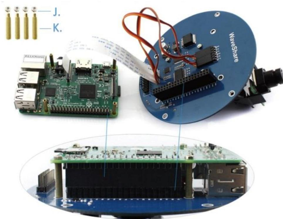
Raccordez ensuite les deux parties du châssis ensemble via la nappe et les vis incluses :
