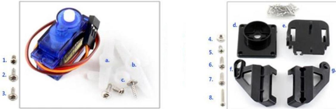
Etape 1. Placez les deux pièces (F) et (G) l'une en face de l'autre en insérant le servomoteur entre les deux et les visser ensemble avec les vis (7).
