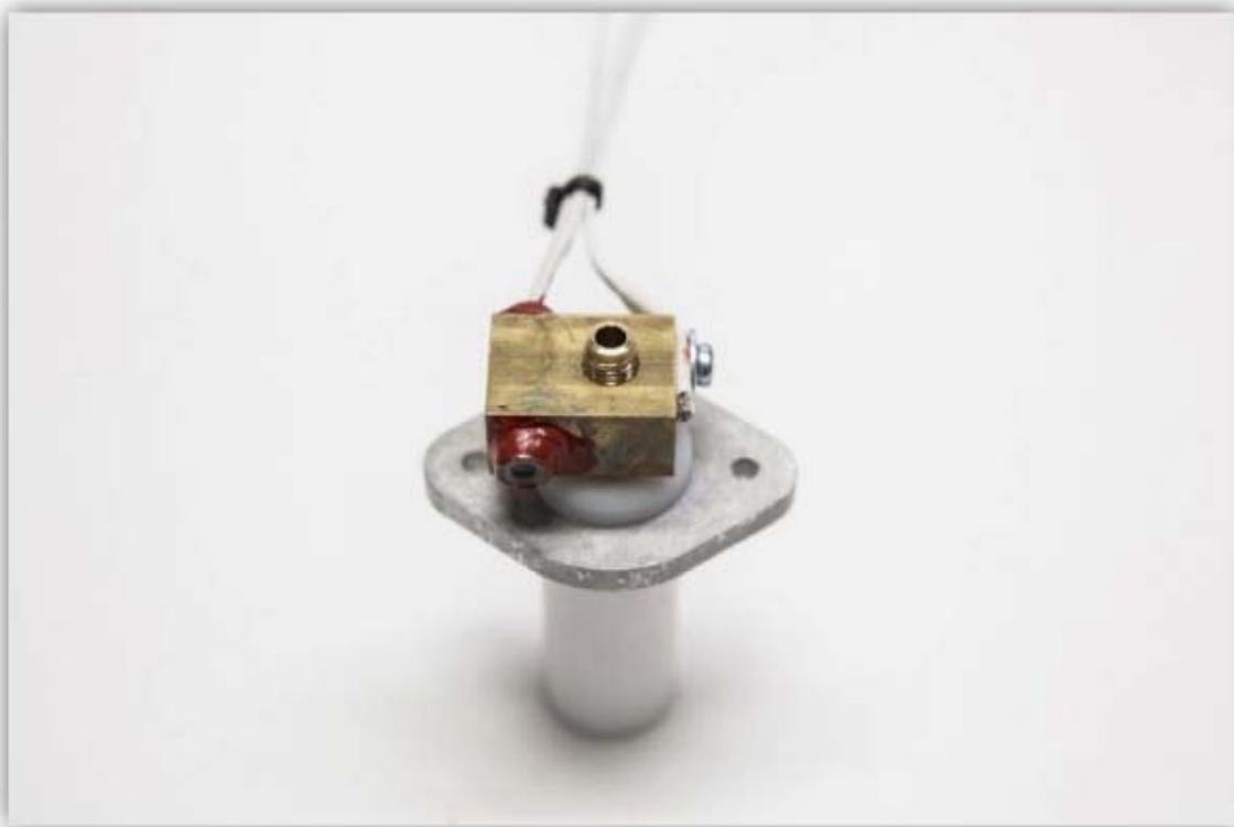
Visser le nez de l'extrudeur sur le barillet. Bloquer solidement. Vous pouvez détacher le cylindre en plastique et utiliser une autre clé sur le barillet en cuivre pour serrer fermement le nez. Ne pas oublier de rattacher solidement le cylindre en plastique par après.
